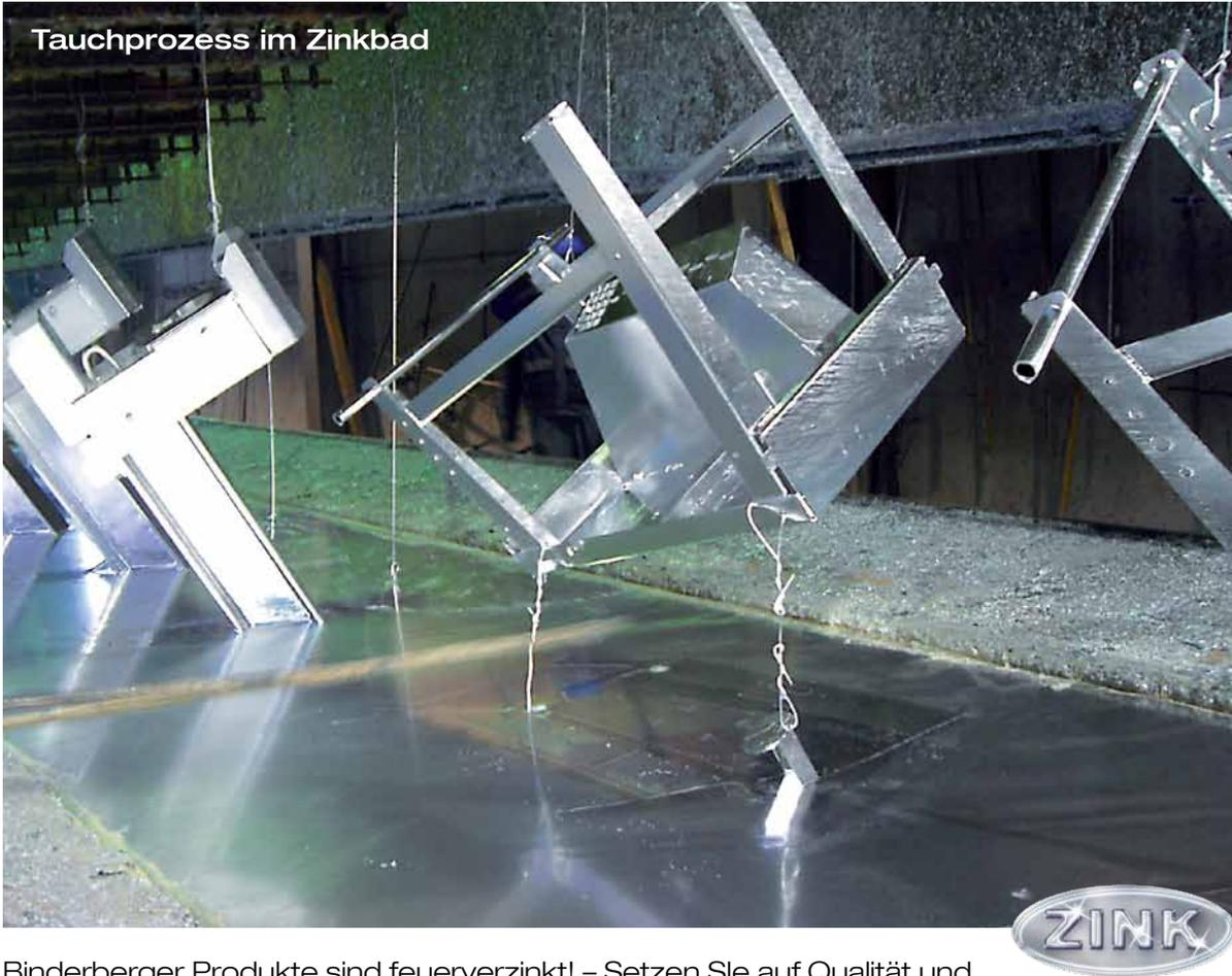
Binderberger Produkte sind feuerverzinkt! – Setzen Sie auf Qualität und profitieren Sie von der Langlebigkeit der Geräte. Wirtschaftlichkeit durch Korrosionsschutz.
