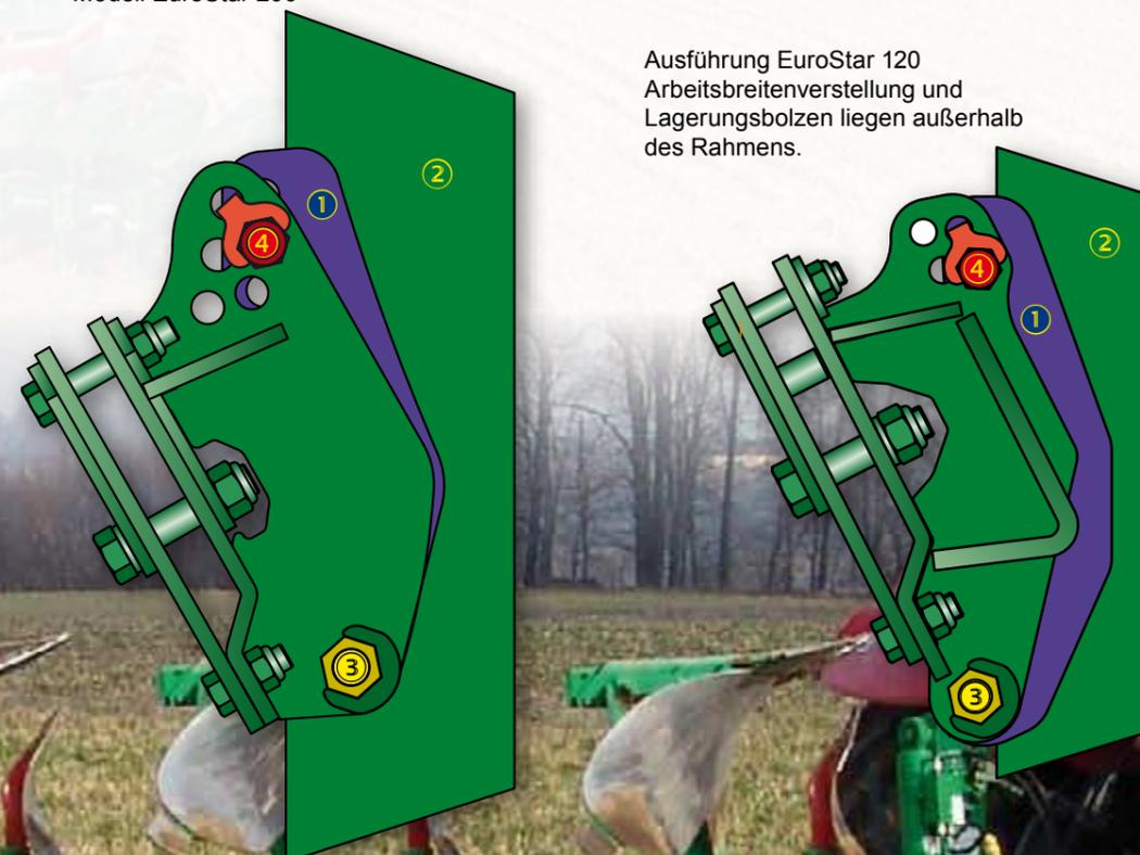
Ausführung EuroStar 120 Arbeitsbreitenverstellung und Lagerungsbolzen liegen außerhalb des Rahmens.
